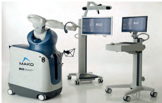
Die MAKOplasty besteht aus 3 Teilen (v. r.): Planungsstation, 3D-Kamera und dem 600 kg schweren Roboter
